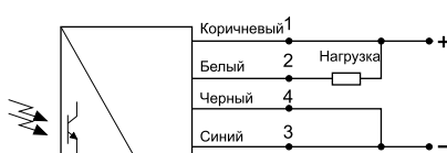
Неприсоединять черный провод SPR 2645 (Нагрузка как NPN)
