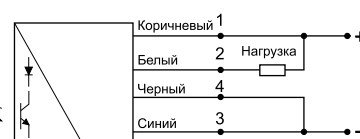
Неприсоединять черный провод SPP/SPRR/SPPR/SPBS 26xx (Нагрузка как NPN)
