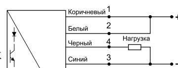
Неприсоединять белый провод SPP/SPRR/SPPR/SPBS 26xx (Нагрузка как PNP)
