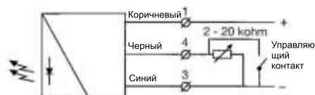
SMT 6000 1-6 m переключатель ON/OFF для подачи питания
