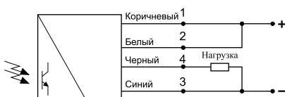
Неприсоединять белый провод SPR 2645 (Нагрузка как PNP)
