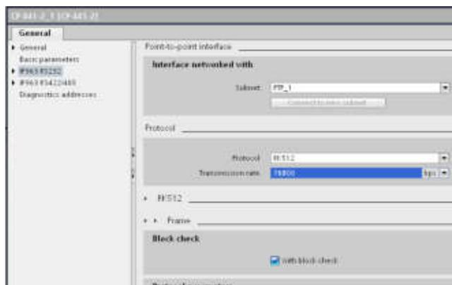
Параметры настройки CP 441 сохраняются в памяти центрального процессора S7-400. Это позволяет производить замену коммуникационного процессора без повторного конфигурирования вновь устанавливаемого модуля. Запуск коммуникационного процессора будет автоматически сопровождаться передачей всех параметров его настройки.
