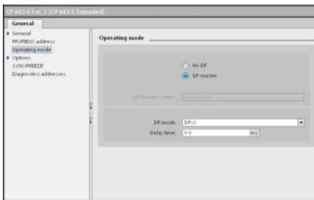
во конфигурирования вновь устанавливаемого модуля. Запуск коммуникационного процессора будет автоматически сопровождаться передачей всех параметров его настройки.
