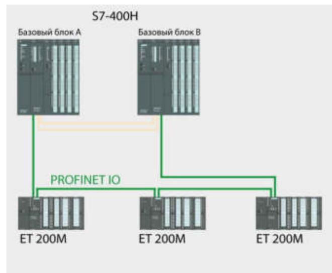
Все датчики и исполнительные устройства подключаются к модулям ввода-вывода по стандартным одноканальным схемам: один канал на датчик/ исполнительное устройство. Доступ ко всем модулям ввода-вывода имеют оба центральных процессора S7-400H. В нормальных режимах работы управление процессом осуществляет только ведущий базовый блок.
