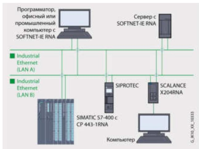
Коммуникационный процессор CP 443-1 RNA оснащен двумя независимыми коммуникационными интерфейсами:
