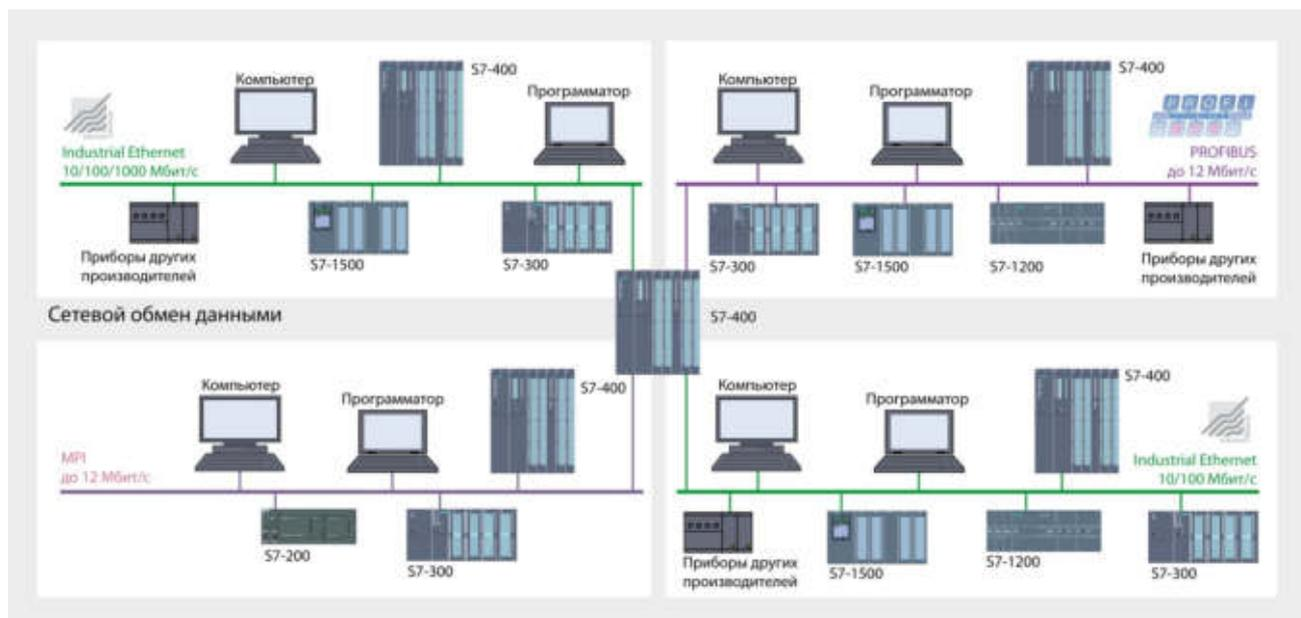
Для организации обмена данными между S7-400 и интеллектуальными сетевыми устройствами (контроллерами, компьютерами, приборами и системами человеко-машинного интерфейса) преимущественно используются сети MPI, PROFIBUS и PROFINET/ Industrial Ethernet с использованием механизмов:
