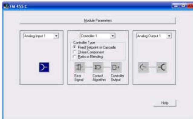
Программирование и настройка параметров модулей FM 455 может выполняться в среде STEP 7 V5.x и выше или в среде STEP 7 Professional от V11 (TIA Portal). В первом случае для программирования и настройки параметров модуля используется включенный в комплект их поставки пакет конфигурирования. Во втором случае все необходимое программное обеспечение интегрировано в пакет STEP 7 Professional от V11.
