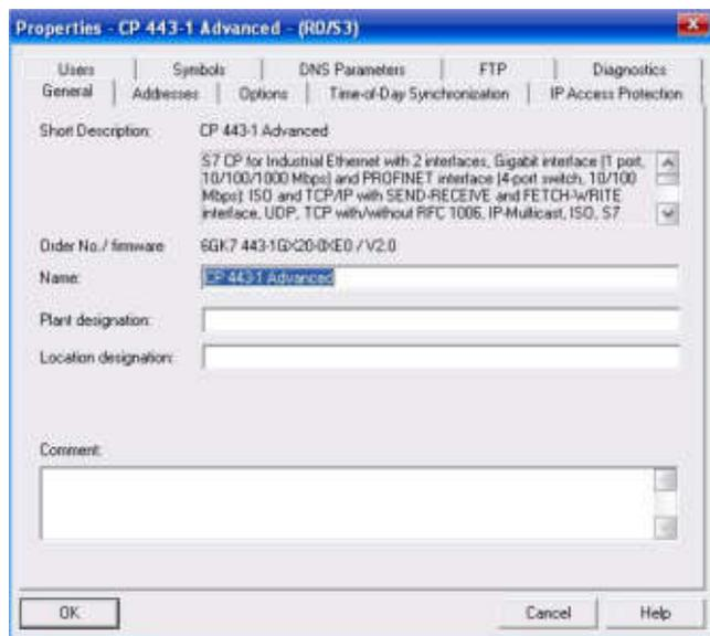
Для конфигурирования всех функций CP 443-1 Advanced необходим STEP 7 V5.5 SP2 и выше. Этот пакет может использоваться для конфигурирования коммуникационных процессоров CP 443-1 Advanced в программируемых контроллерах S7-400, S7-400H и S7-400F/FH. Операции программирования и настройки параметров программируемых контроллеров S7-400 могут выполняться дистанционно через сеть.
