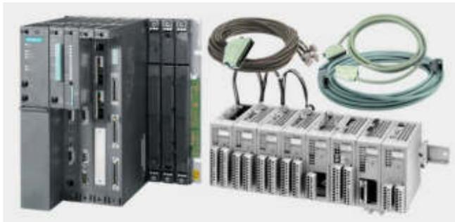
Интерфейсные модули подключаются к соединителям модулей FM 458-1 DP и EXM 438-1 с помощью соединительных кабелей соответствующих типов.
