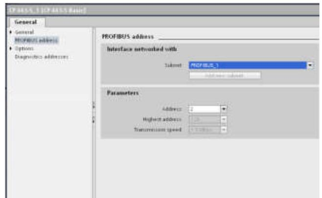
Конфигурирование коммуникационного процессора CP 443-5 Basic в программируемых контроллерах S7-400 и S7-400F/H/FH выполняется с помощью пакета NCM S7 для PROFIBUS, являющегося составной частью пакета STEP 7 от версии 5.1 SP2 и выше.
