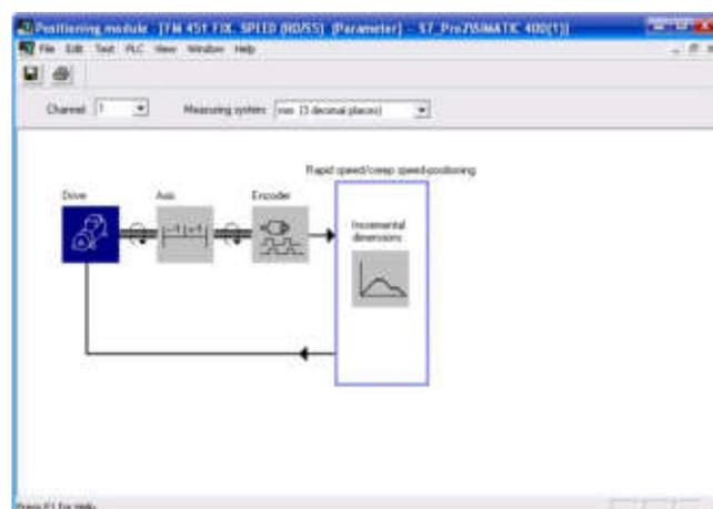
Программирование и настройка параметров модуля FM 451 может выполняться в среде STEP 7 от V5.0 SP2 и выше или в среде STEP 7 Professional от V11 (TIA Portal). В первом случае для программирования и настройки параметров модуля используется включенный в комплект его поставки пакет конфигурирования. Во втором случае все необходимое программное обеспечение интегрировано в пакет STEP 7 Professional V11.
