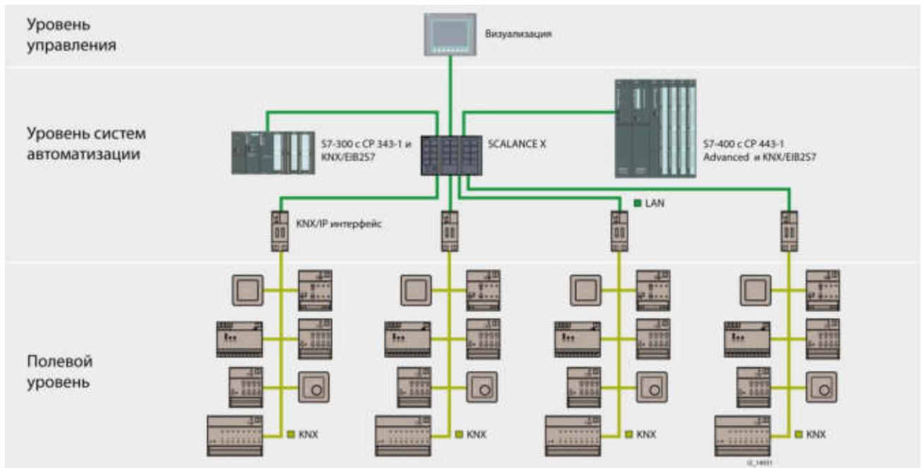
Программируемые контроллеры S7-300/ S7-400 способны поддерживать обмен данными с компонентами систем автоматизации зданий на основе сети KNX. Это позволяет интегрировать системы автоматизации зданий в комплексные системы автоматизации производства. Интеграция сетей KNX/EIB в системы управления на основе S7-300/ S7-400 выполняется с помощью программного обеспечения KNX/EIB2S7.
