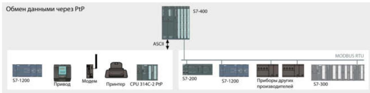
Программируемый контроллер S7-400 позволяет устанавливать высокопроизводительные непосредственные (PtP – Point-to-Point – точка к точке) соединения через различные типы последовательных интерфейсов. Эти варианты связи поддерживаются коммуникационными процессорами CP 440 и CP 441, в которых могут использоваться последовательные интерфейсы TTY (20 мА токовая петля); RS 232C/V.24 или RS 422/RS 485.
