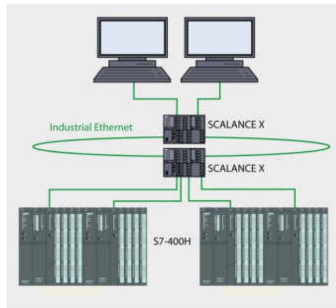
Подключение к кольцевой сети Industrial Ethernet через два коммуникационных процессора CP 443-1 (ISO) или через встроенные интерфейсы PROFINET центральных процессоров CPU 41x-5H (ISO on TCP)
