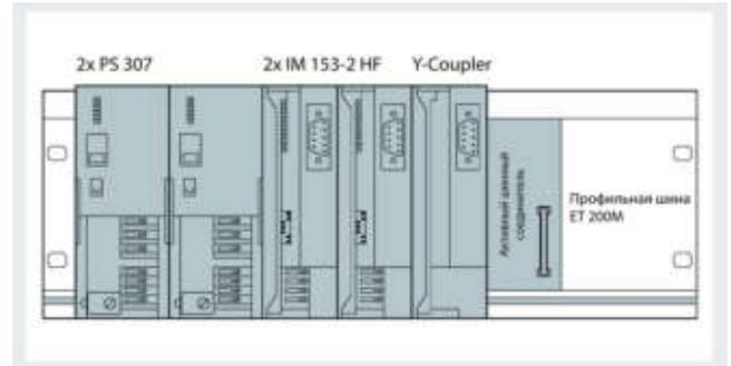
Блок связи Y-Link выполняет функции согласующего устройства между резервированной и стандартной сетью PROFIBUS DP. С его помощью к ведущему DP устройству резервированной сети PROFIBUS DP (например, к программируемому контроллеру S7-400H/FH) могут подключаться стандартные ведомые DP устройства. В резервированной сети PROFIBUS DP блок связи Y-Link выполняет функции ведомого, в стандартной сети PROFIBUS функции ведущего DP устройства.
