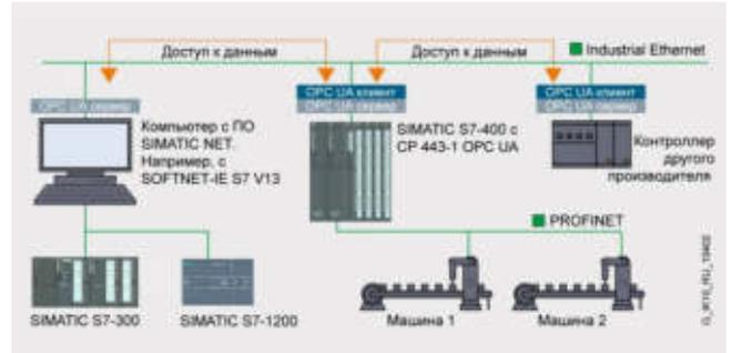
OPC UA формирует стандартный интерфейс обмена данными между программируемым контроллером SIMATIC S7-400 и системами автоматизации других производителей. В режиме OPC UA сервера коммуникационный процессор CP 443-1 OPC UA предоставляет стандартный и безопасный доступ к данным S7-400 со стороны OPC UA совместимых систем человеко-машинного интерфейса, SCADA систем и баз данных, выступающих в роли OPC UA клиентов.
