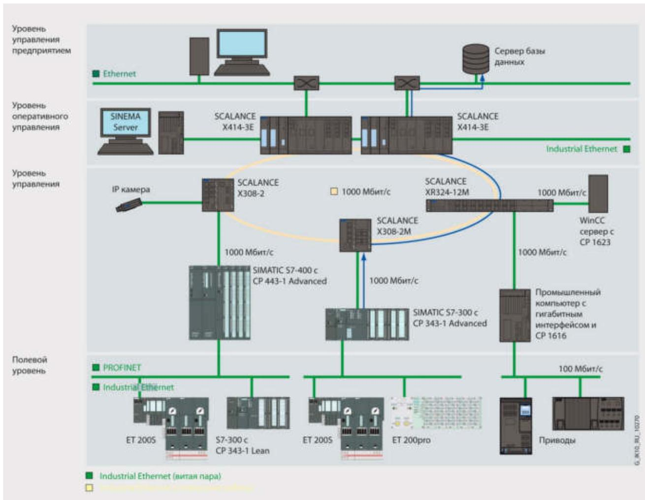
Обмен данными через Ethernet со скоростью 1 Гбит/с
