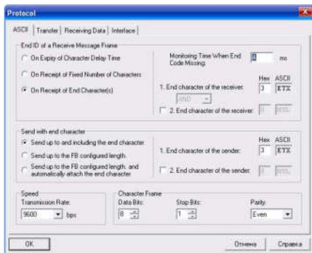
Конфигурирование коммуникационных процессоров CP 441 в программируемых контроллерах S7-400 и S7-400F/H/ FH выполняется с помощью пакета конфигурирования, включенного в комплект их поставки и интегрируемого в среду STEP 7 V5.3 и выше.
