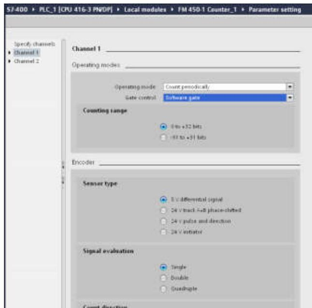
Программирование и настройка параметров модуля FM 450-1 может выполняться в среде STEP 7 от V5.0 SP2 и выше или в среде STEP 7 Professional от V11 (TIA Portal). В первом случае для программирования и настройки параметров модуля используется включенный в комплект его поставки пакет конфигурирования. Во втором случае все необходимое программное обеспечение интегрировано в пакет STEP 7 Professional V11.
