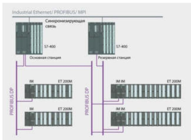
На базе программируемых контроллеров S7-400 со стандартными центральными процессорами и программного обеспечения S7-Redundancy могут создаваться относительно недорогие резервированные системы автоматизации, характеризующиеся следующими показателями:
