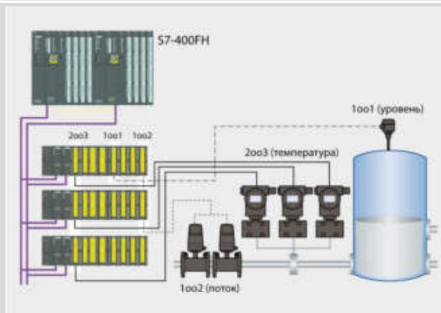
Программируемые контроллеры S7-400F/FH способны поддерживать различные варианты подключения и обработки сигналов датчиков обеспечения безопасности:
