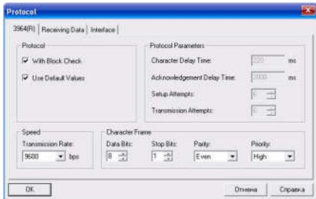
Конфигурирование коммуникационного процессора CP 440 в программируемых контроллерах S7-400 и S7-400F/H/ FH выполняется с помощью пакета конфигурирования, включенного в комплект поставки модуля, интегрируемого в среду STEP 7 V5.x и выше.
