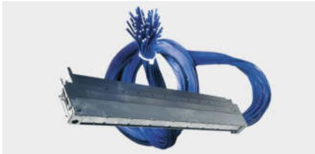
Гибкие соединители предназначены для непосредственного соединения модулей ввода-вывода программируемого контроллера S7-400 с различными элементами шкафа управления. Каждый гибкий соединитель состоит из стандартного фронтального соединителя с подключенным к нему жгутом проводов. Свободные концы проводов промаркированы в соответствии с их подключением к контактам фронтального соединителя.
