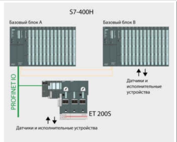
Все датчики и исполнительные устройства подключаются к модулям ввода-вывода по стандартным одноканальным схемам: один канал на датчик/ исполнительное устройство. Обращение к модулям ввода-вывода способен выполнять только один из двух центральных процессоров контроллера. Модули ввода-вывода могут устанавливаться:
