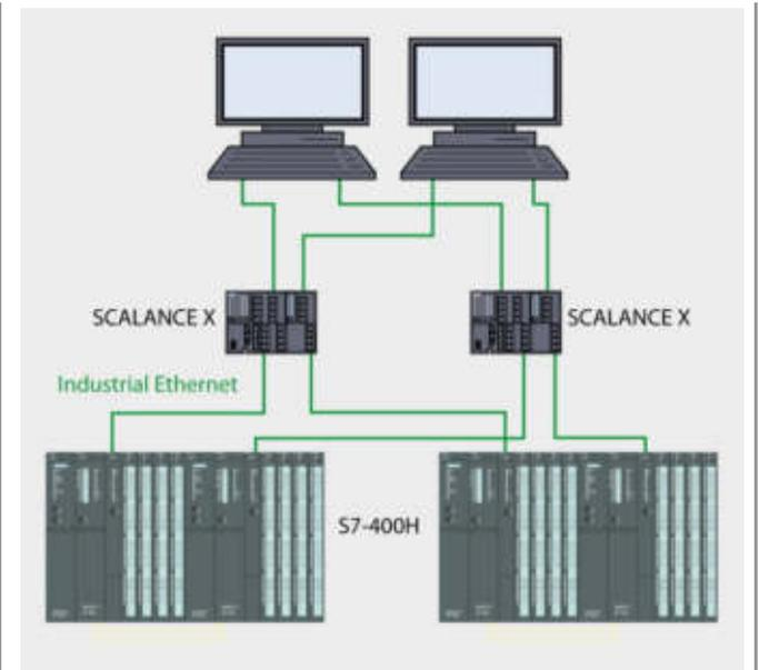
Подключение к резервированной сети Industrial Ethernet через два коммуникационных процессора CP 443-1 (ISO) или через встроенные интерфейсы PROFINET центральных процессоров CPU 41x-5H (ISO on TCP)
