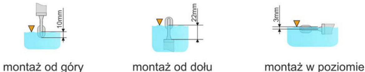
Рис. 9. Способы монтажа датчика WSP-4 и соответствующие уровни переключения.
