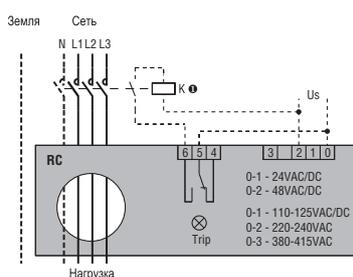
Подсоединение катушки может меняться в зависимости от типа подсоединенного устройства (контактора, выключателя с катушкой расцепления или выключателя с катушкой минимального напряжения).
