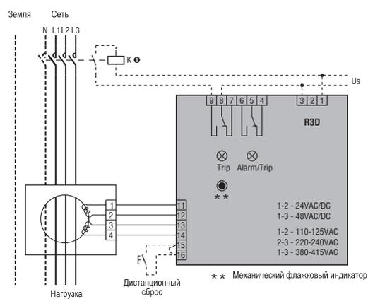
Подсоединение катушки может меняться в зависимости от типа подсоединенного устройства (контактора, выключателя с катушкой расцепления или выключателя с катушкой минимального напряжения).
