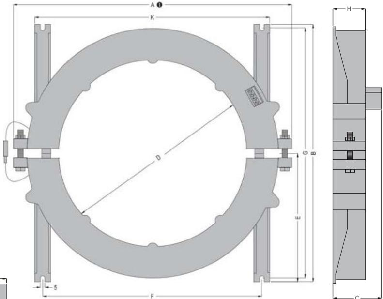
● С винтами только для разборных реле типа RTA210; неразборная конструкция без винтов для реле типа RT210.
