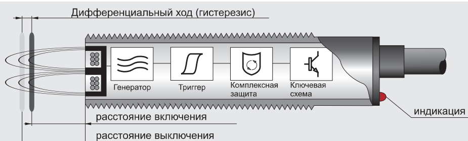
Рисунок 1. Схема функциональная индуктивного датчика с комплексной защитой
