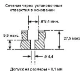
Рис. 15 – Размеры отверстий для установки шасси
