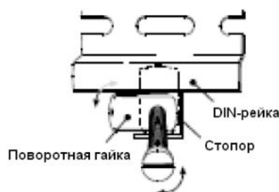
Рис. 16 – Крепление при помощи винта и поворотной гайки
