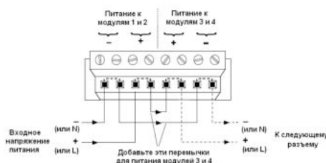
Рис. 20 – Подключение одного внешнего источника питания
