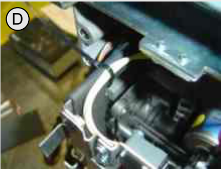
Fig. A: Bell Alarm Kit Fig. B: Assembly of Bell alarm Fig. C: Fixing the screws Fig. D: Assembling wire tie Fig. E: Assembly of connectors Fot. A: Сигнальный контакт Fot. B: Крепление сигнального контакта Fot. C: Винчивание винтов Fot. D: Кабельная стяжка Fot. E: Подключение проводов Fot. A: Łącznik alarmowy Fot. B: Zamocowanie łącznika alarmowego Fot. C: Wkręcenie śrub Fot. D: Opaska kablowa Fot. E: Podłączenie przewodów
