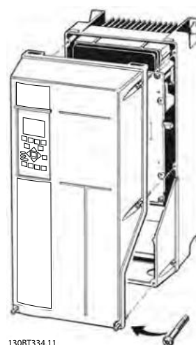
Abbildung 3.10 Zugriff auf die Steuerverdrahtung in den Gehäusen IP 55 und IP 66 4/4X Indoor
